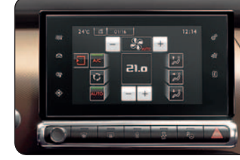
Die Klimaautomatik lässt sich einfach über den Touchscreen steuern
