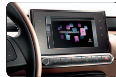
Der Touchscreen als zentrales Bedienelement ersetzt eine Armada von Tasten
