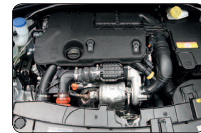
Sparsamer 1,6-Liter-Vierzylinder-Turbodiesel – schadstoffarm nach Euro-6-Norm
