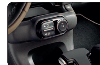
Das automatisierte Schaltgetriebe wird vom Armaturenbrett aus gesteuert
