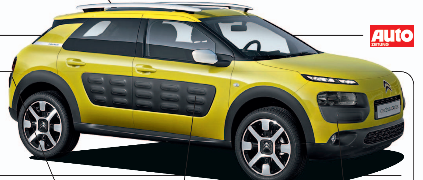
Die Airbumps aus luftgefüllten Kunststoffpolstern sehen schick aus und reduzieren bei leichten Remplern die Reparaturkosten
